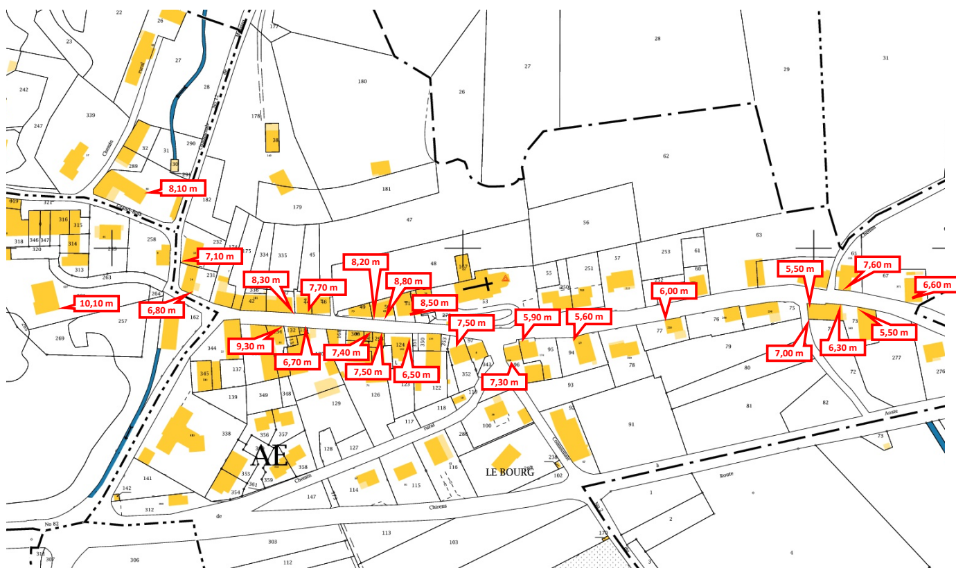
Relevé des hauteurs de faîtage dans le bourg :
