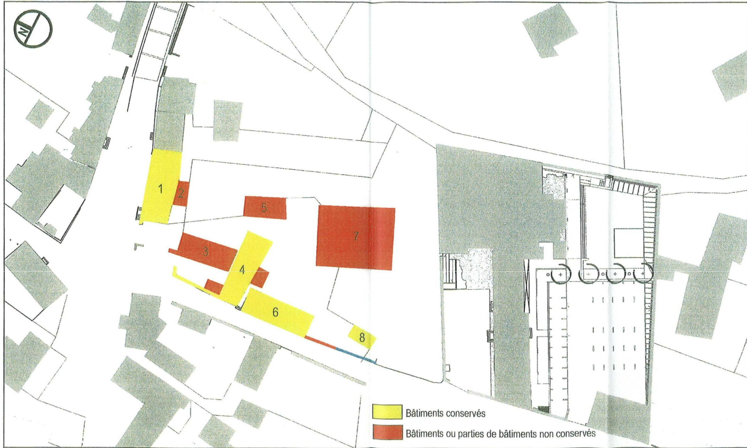
Bâtiments existants conservés ou non suivant l'appréciation de l'état du bâti ou de l'intérêt patrimonial
