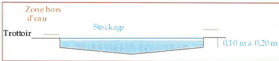
Coupe type d'une voirie avec stockage en surface – la pente longitudinale de la voirie est nulle sur le tronçon :
