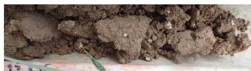
Photo 19. Echantillon Sondage S20 de 25 à 50 cm - Aucun trait d'hydromorphie sur matrice argilo-limoneuse
