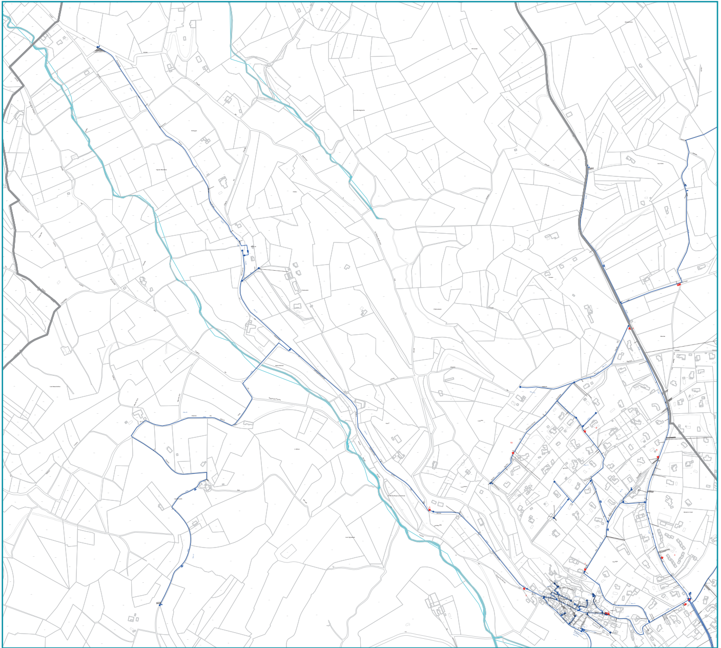
Disposition du réseau collectif d'eau potable dans la partie nord du territoire (source : Syndicat Rhône Ventoux)
