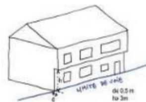
Ouvrage en saillie sur voie
