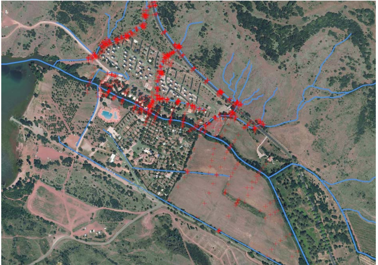
Figure 38 : Localisation des points topographiques levés
