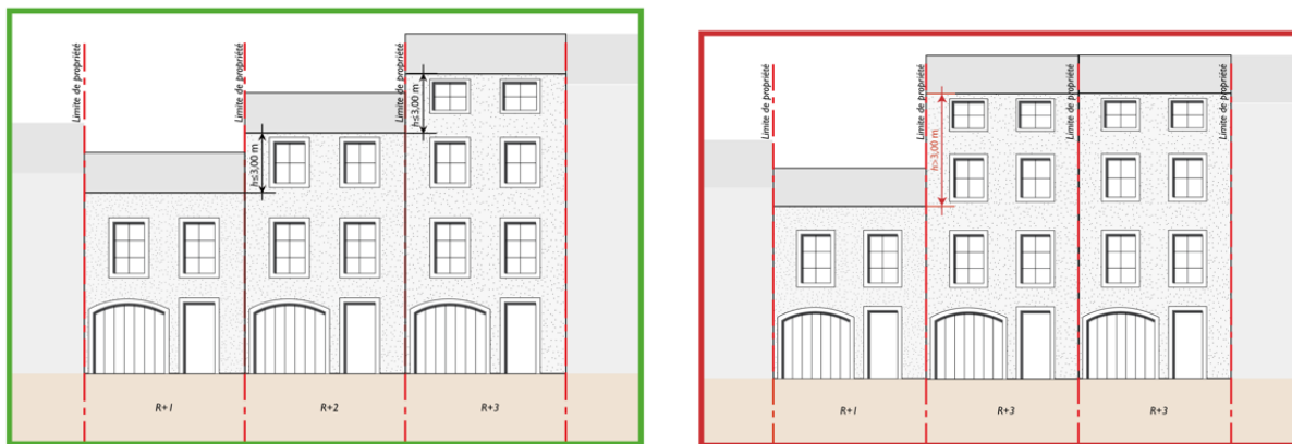
Schéma explicatif : Principes des hauteurs de construction
