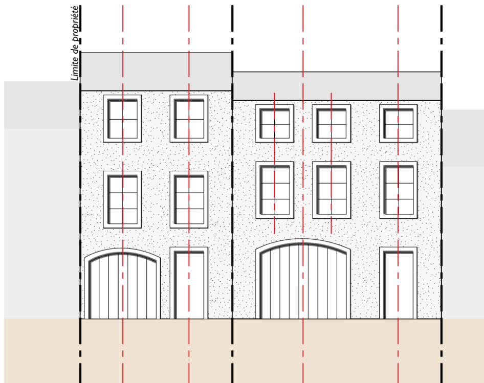
Schéma explicatif : Principe d'harmonie dans l'ordonnement des ouvertures
