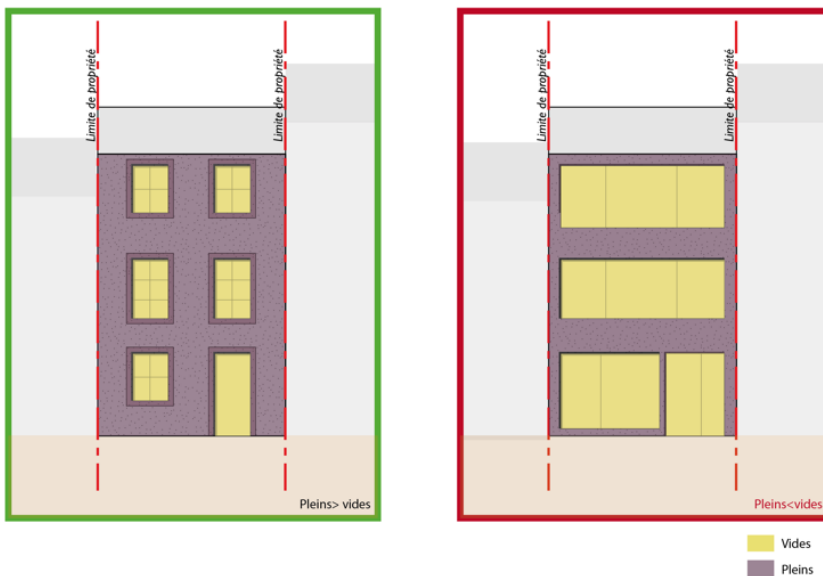
Schéma explicatif : Principe du respect des proportions pleins/vides
