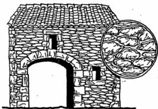
1- Remises en maçonnerie de tout-venant (pierres non taillées) sans enduit : à rejointoyer si ces bâtiments ne changent pas de fonction.
